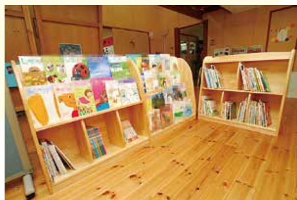
本体に傾きがあり、絵本が落ちにくい構造になっています
